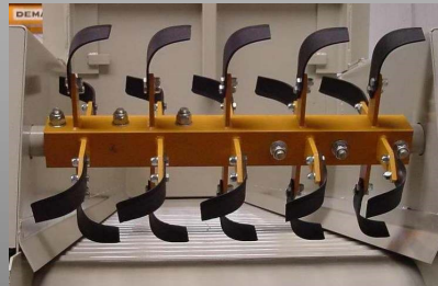
Aspo a fresa per materiale umido Self cleaning picker for sticky material Dévidoirs auto-nettoyant pour matière humide
